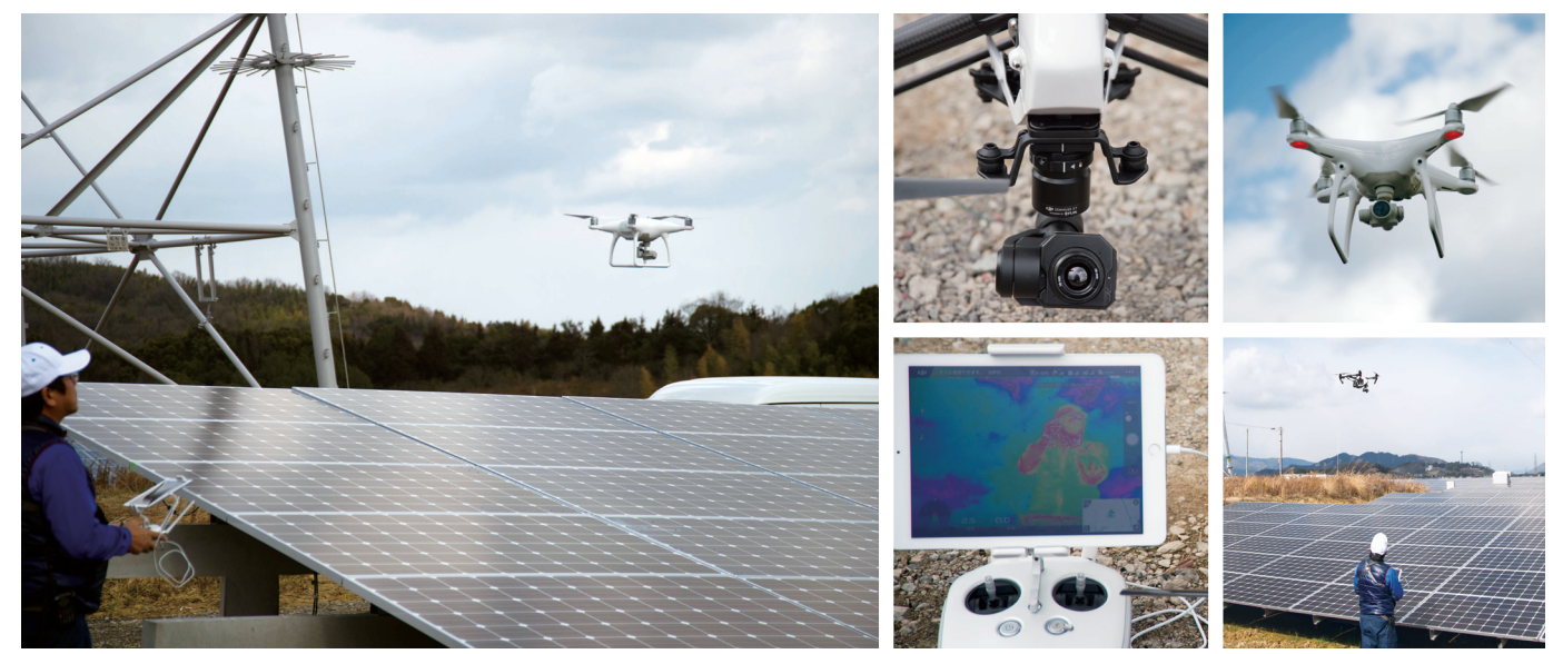
太陽光パネル破損状況やホットスポットの有無を確認
